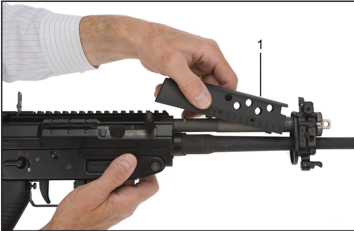
Bild 4: Kunststoffhandschutz zu GL 5340 / GwA 04 montieren
