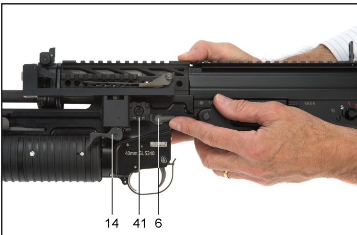
Bild 10: Hebel in horizontale Position umlegen
