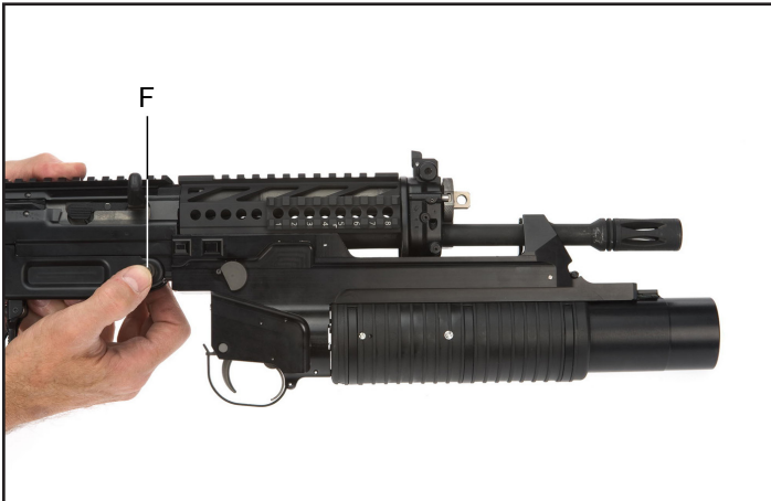
Bild 9: Vorderen Abzuggehäusebolzen durchdrücken
