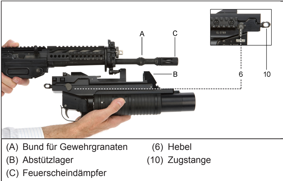
Bild 6: GL 5340 am SG553 montieren
