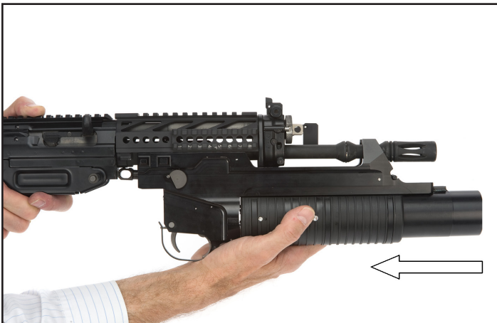
Bild 8: GL 5340 nach hinten ziehen
