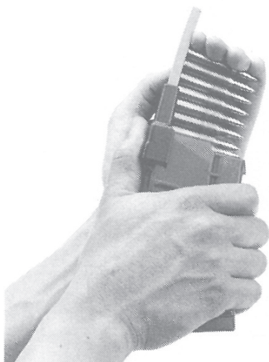
Einfüllen der Patronen mit Hilfe des Ladeaufsatzes
