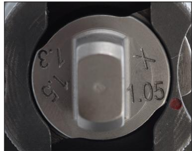
**Bild 51: Gasdüsenstellung III**
