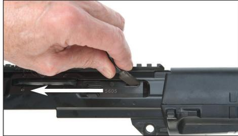
**Bild 66: Verschluss mit Ladegriff nach hinten ziehen**
