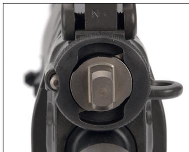
Bild 43: Gasdüsenstellung I
