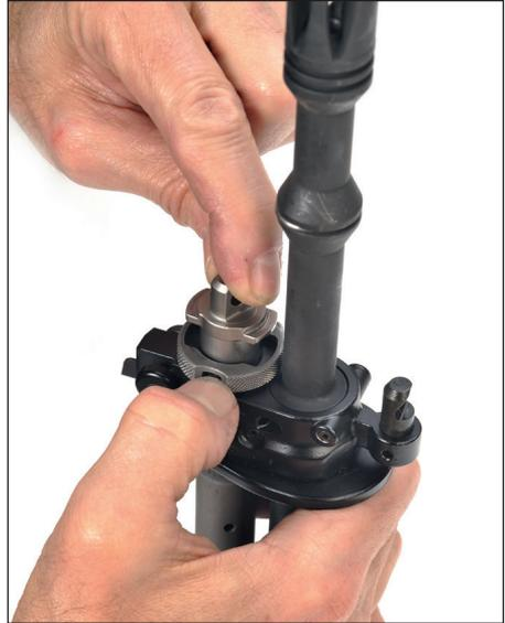
**Bild 70: Gasdüse ausbauen**
