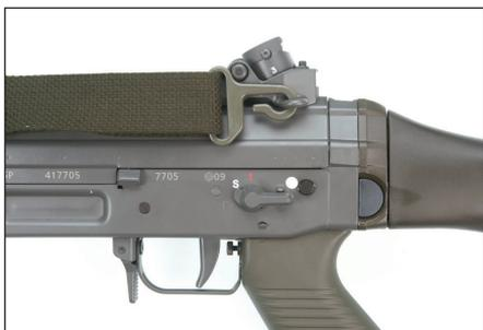
**Bild 59: Einhängen des Tragriemens am Visierträger**
