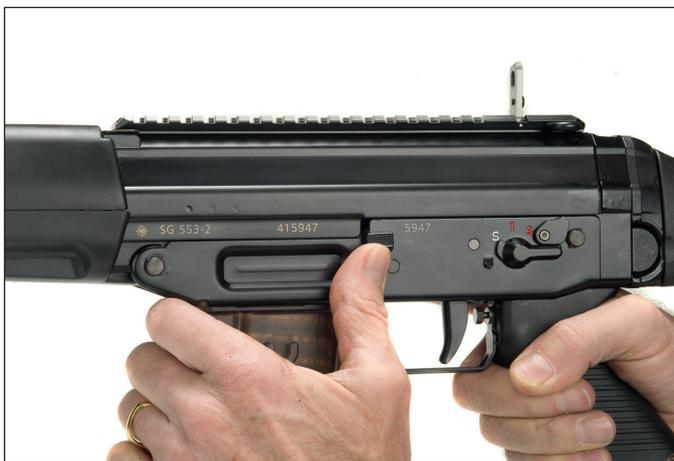
**Bild 33: Hochdrücken des Verschlusshalters**
