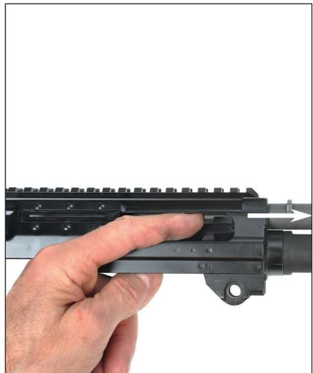
**Bild 71: Gasstange hinausschieben**
