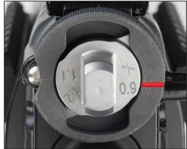
**Bild 47: Gasdüsenstellung III (LB)**
