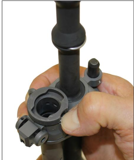
**Bild 72: Arretierstift hineindrücken, Gasrohr 90° drehen**
