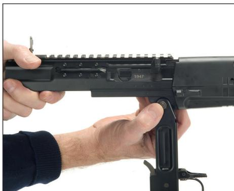
**Bild 64: Abzugvorrichtung entfernen**
