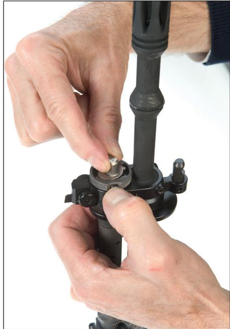
**Bild 84: Gasdüse einbauen**
