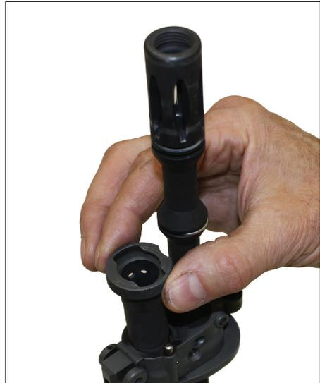
**Bild 82: Gasrohr einbauen**
