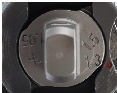
Bild 49: Gasdüsenstellung I
