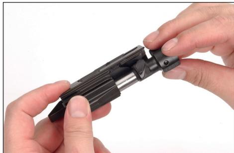
**Bild 68: Verschlusskopf herausziehen**
