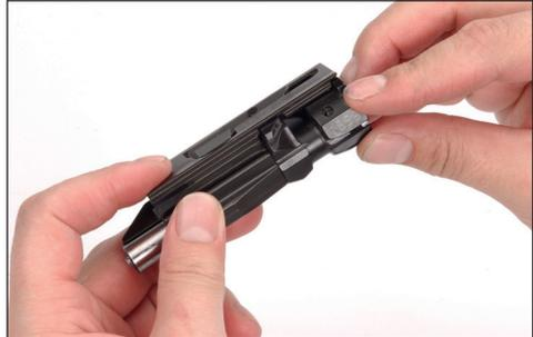
**Bild 67: Verschlusskopf herausdrehen**
