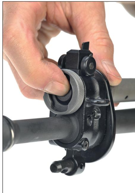
**Bild 83: Gasstange einbauen**
