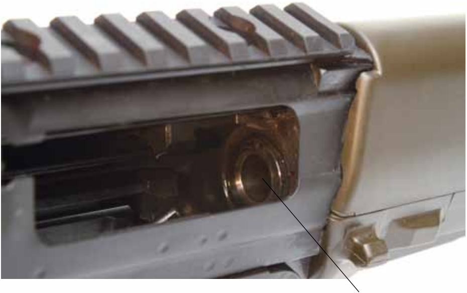
Bild 17: Kontrolle des Patronenlagers
