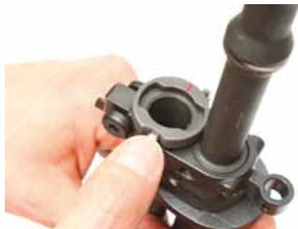
Bild 41: Arretierstift hineindrücken, Gasrohr 90° drehen
