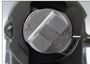
Bild 32: Gasdüsenstellung II (SB)
