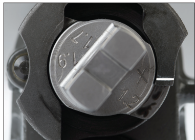
Bild 34: Gasdüsenstellung IV (SB)
