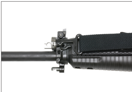
Bild 38: Einhängen des Tragriemens am Kornträger
