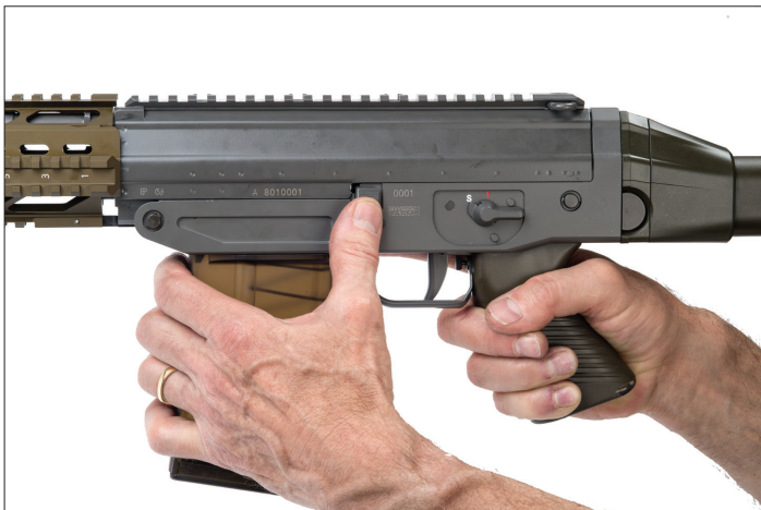
Bild 28: Hochdrücken des Verschlusshalters
