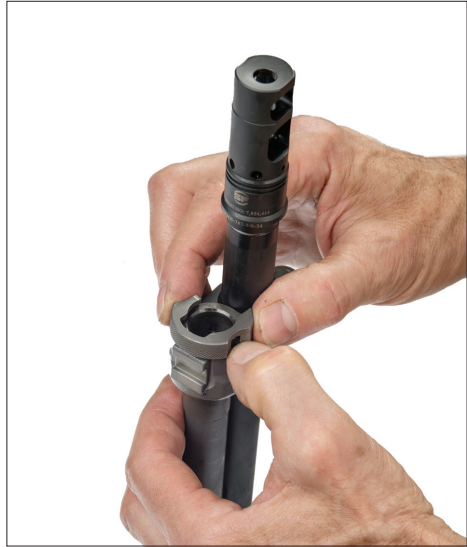
Bild 50: Arretierstift hineindrücken, Gasrohr 90° drehen
