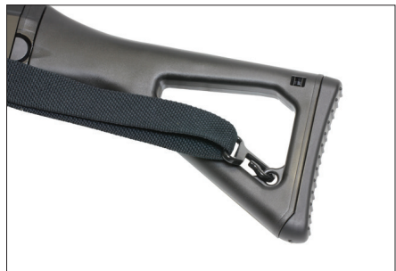
Bild 41: Einhängen des Tragriemens am Kolben
