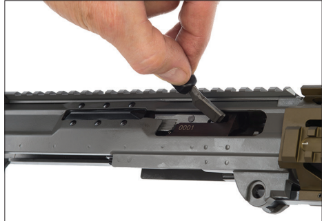
Bild 44: Verschluss mit Ladegriff nach hinten ziehen
