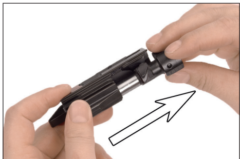
Figure 51: Remove bolt head (pull)
