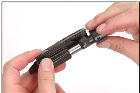
Figure 51: Remove bolt head (pull)
