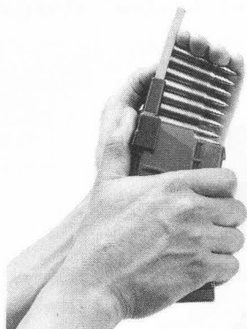
Engager les cartouches dans le chargeur à l'aide du guide-charge
