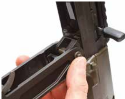
Figure 47: Enlever le bloc détente
