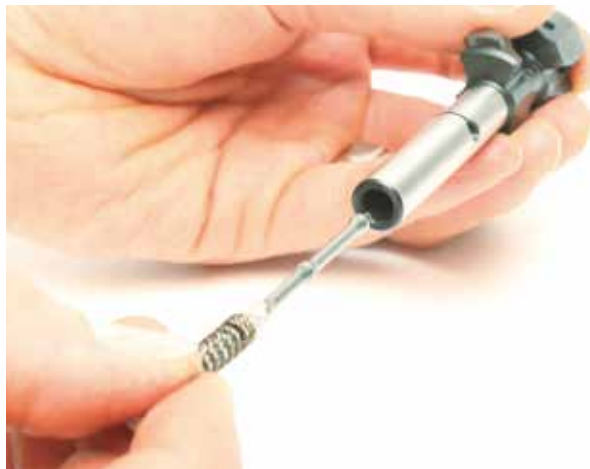
Figure 61: Installation de la goupille de tir
