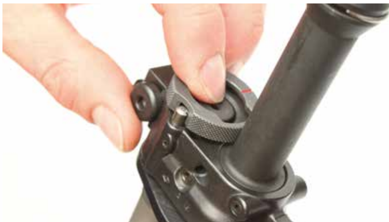
Figure 62: Vérification de la position du piston à gaz
