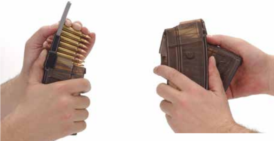
Figure 28: Approvisionnement du chargeur
