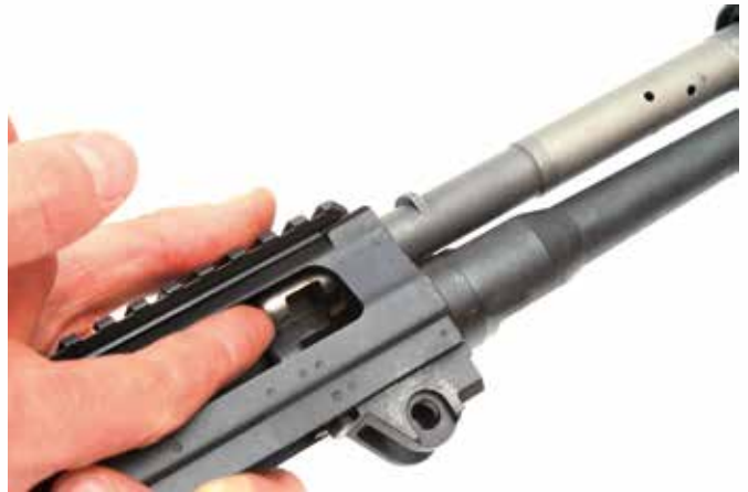
Figure 54: Enlever le piston de gaz
