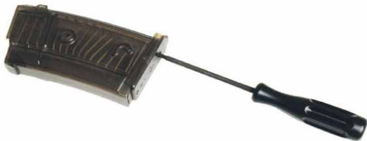
Figure 56: Démontage du chargeur
