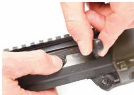
Figure 48: Enlever le levier de chargement
