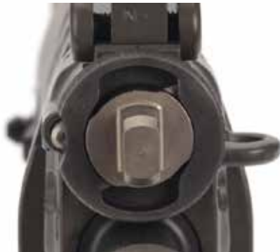
Figure 37: Valve de gaz en position I
