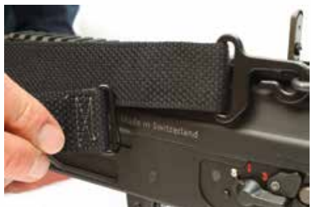
Figure 46: Attache de la sangle sur la crosse
