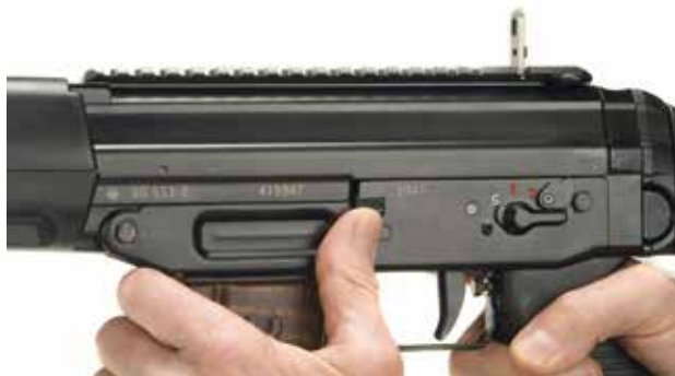
Figure 27: Pousser le verou de culasse
