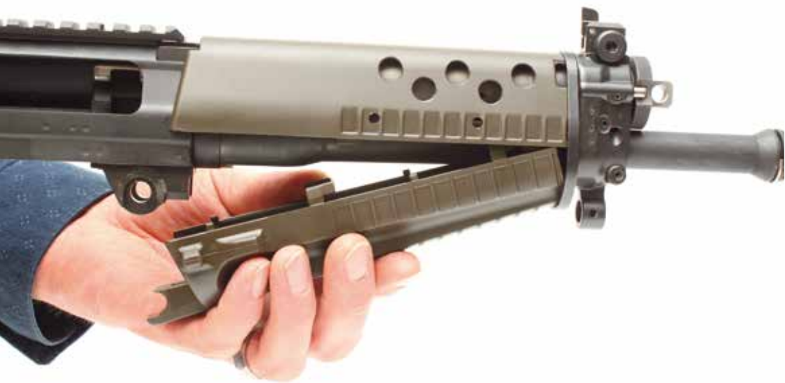
Figure 52: Décollage la partie basse de la poignée garde main
