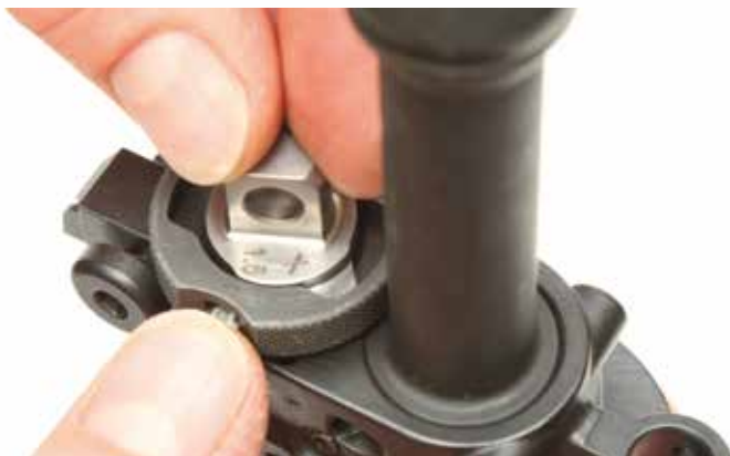
Figure 63: Installation de la valve à gaz
