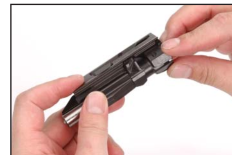
Figura 55: Ruotare la testa dell'otturatore
