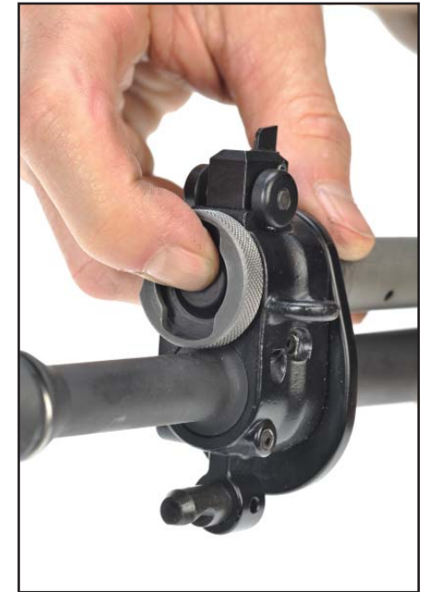
Figura 67: Montare l'asta di armamento
