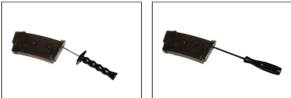
Figura 61: Scomporre il caricatore
