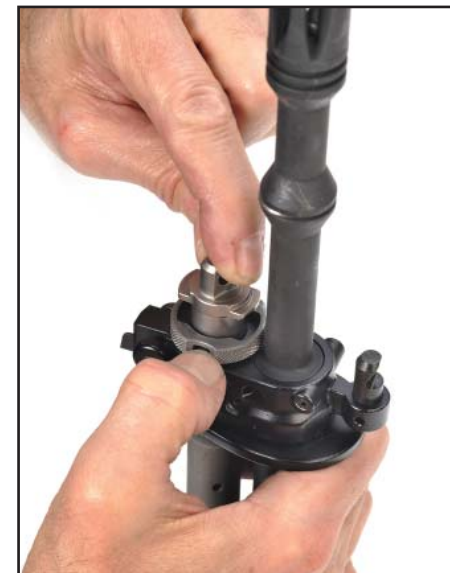
Figura 58: Smontare la valvola gas
