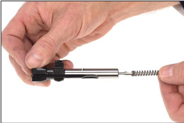
Figura 66: Montare il percussore
