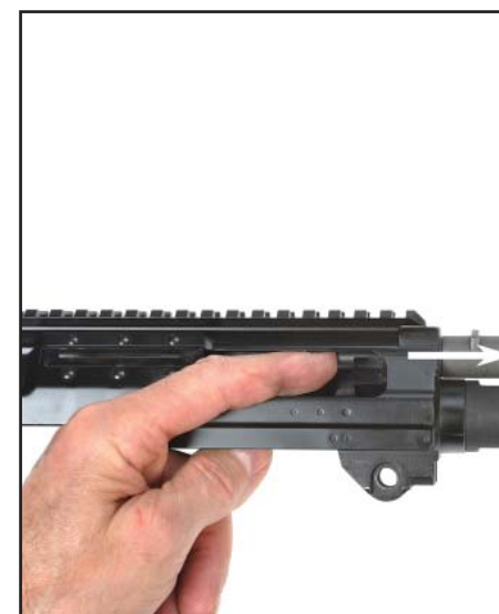
Figura 59: Spingere fuori l'asta di armamento
