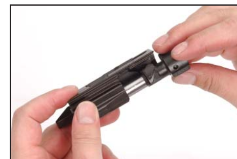
Figura 56: Estrarre la testa dell'otturatore
