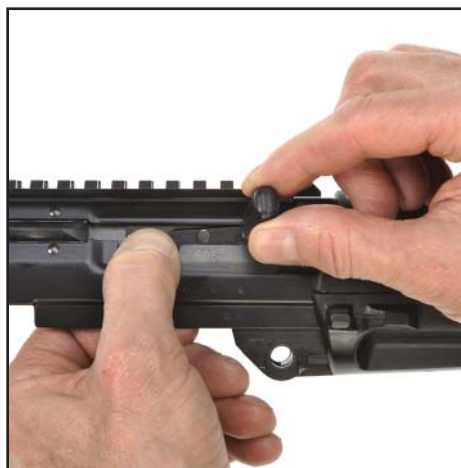
Figura 53: Estrarre la leva d'armamento
