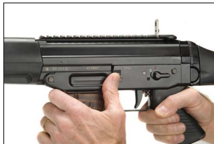
Figura 30: Sollevare l'arresto dell'otturatore
