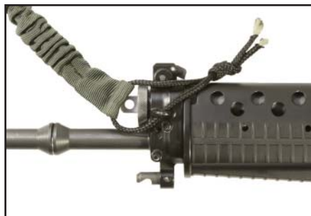
Figura 46: Aggancio della bretella «Kastinger» sul portamirino
