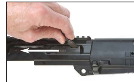
Figura 54: Spingere l'otturatore con la leva d'armamento all'indietro
