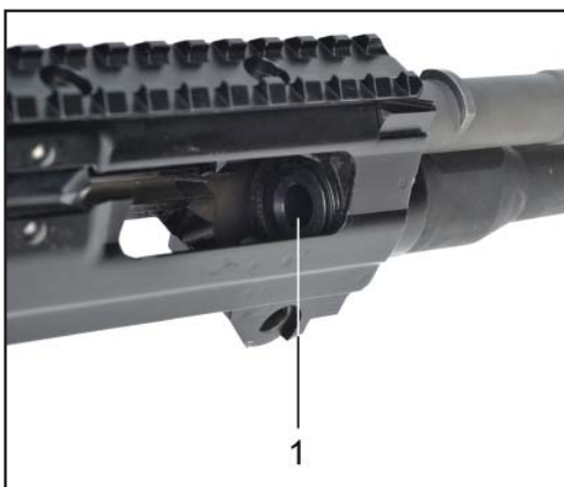
Figura 29: Controllo della camera di caricamento
