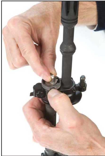
Figura 68: Montare la valvola gas
