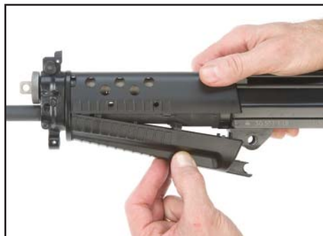
Figura 57: Sollevare la parte inferiore del paramano
